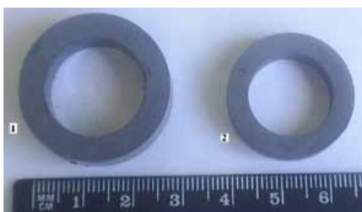
Figura 6: Amostra de composição WC-6Co (1) a verde - (2) sinterizada a 1450°C.
